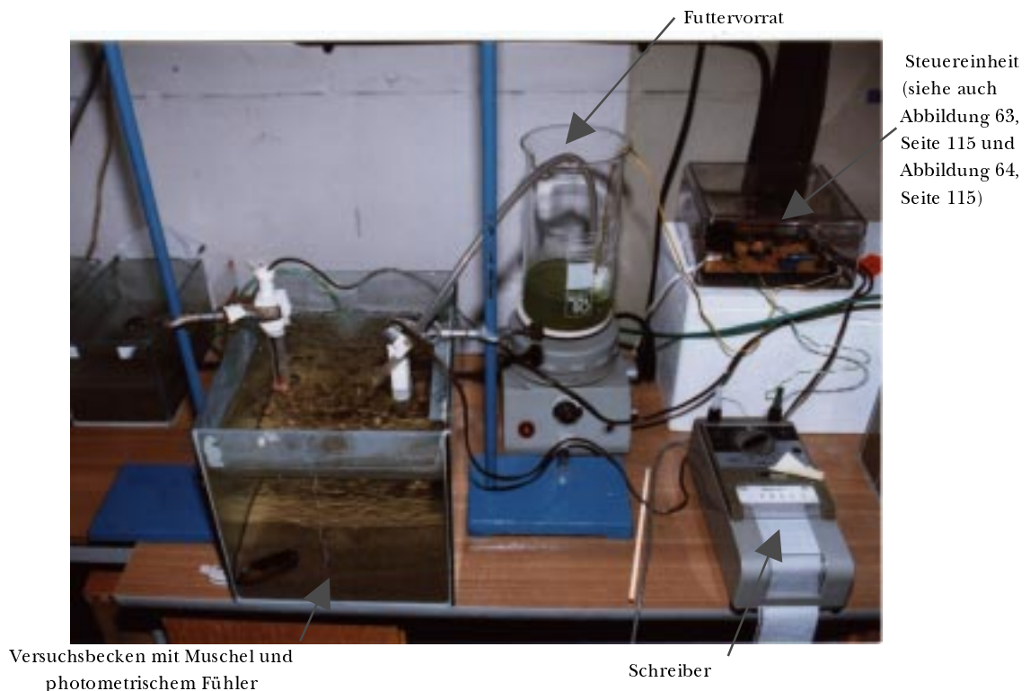
Abbildung 17: Der Versuchsaufbau der Filtrationsmessung.
